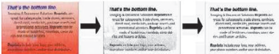
Durch eine falsche Binarisierung können für die OCR-Engine wertvolle Textinformationen während der Digitalisierung verloren gehen.
